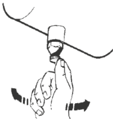
Válvula de drenaje de condensados - Figura 8.
